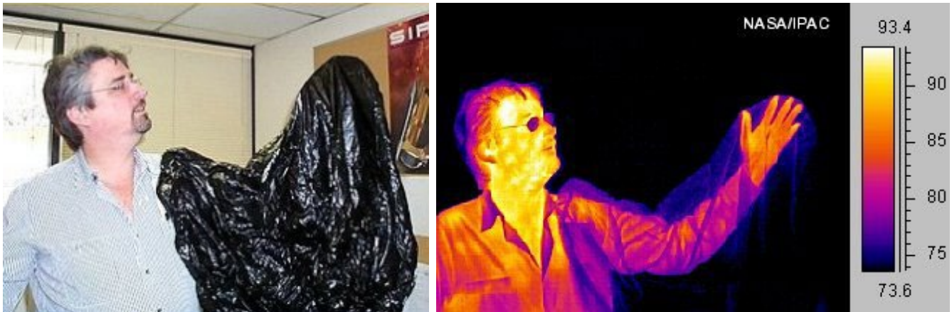
Imagen 15. Dos fotografías de la misma persona tomada con una cámara normal (izq.) y con una cámara infrarroja (der.). Crédito: NASA/IPAC.
